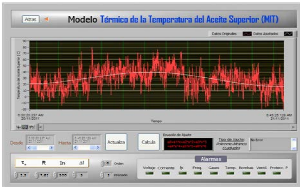
Fig. 16. Ventana visualizando la temperatura del aceite superior mediante el cálculo del MIT.
