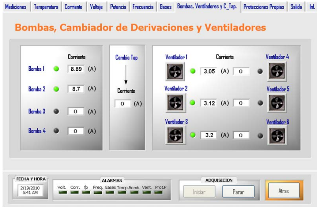
Fig. 15. Ventana visualizando es estado y la corriente de consumo de las bombas, los ventiladores y el cambia derivaciones del AT.
