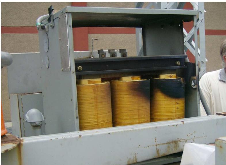
**Fig. 3. Daño en el transformador elevador de 480/660 V.**
