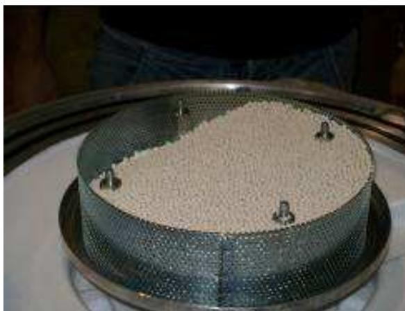
**Fig. 9. Filtro con material desecante.**
