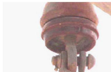
Muestra de perforación en el aislador del cable de guarda.
