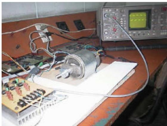
Fig. 13 Empleo de la instalación experimental en el control de un motor CD. Señal del osciloscopio Voltaje en la armadura.
