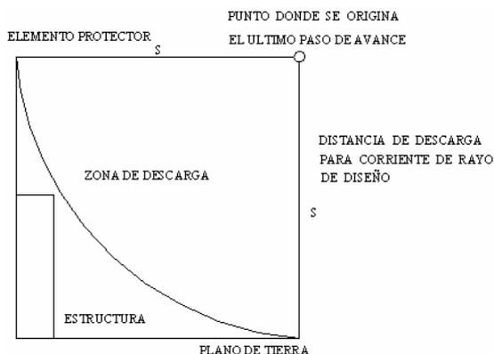
**Fig. 2. Protección contra descargas atmosféricas de corriente pico igual a la de diseño.**
