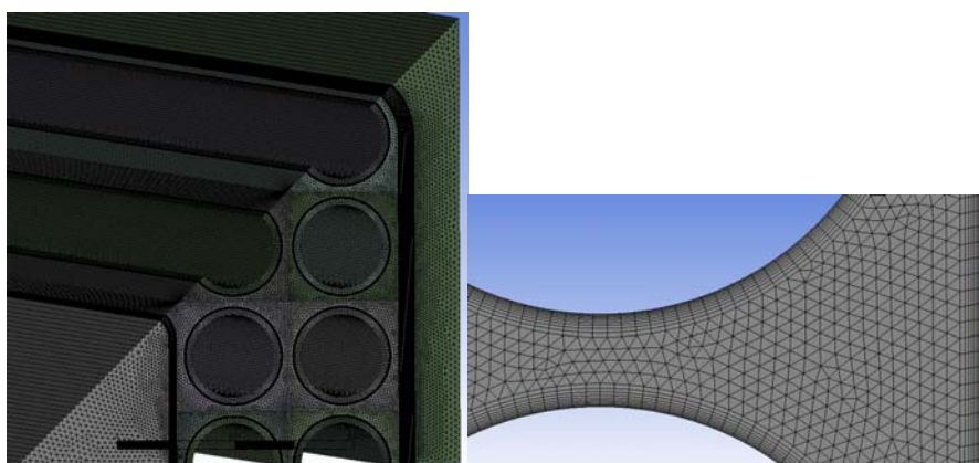
Fig. 6. Elementos de la malla generada.
