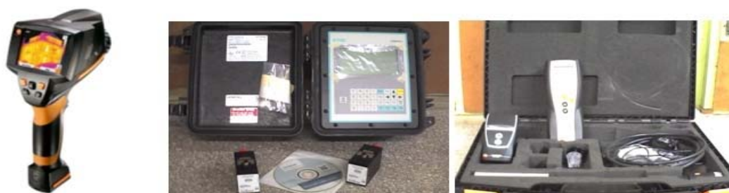
Fig. 2. De izquierda a derecha: cámara termográfica, flujómetro ultrasónico, analizador de gases de la combustión.
