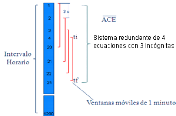
Fig. 8. Obtención del sistema redundante de cuatro ecuaciones con tres incógnitas necesario para la aplicación del método de los mínimos cuadrados.
