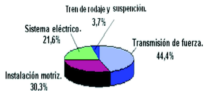
Comportamiento de las fallas en los vehículos a partir de los datos disponibles.
