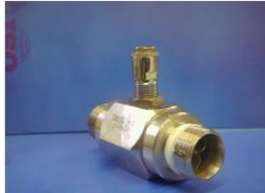
Flujómetro de turbina con conexión roscada y captador inductivo.
