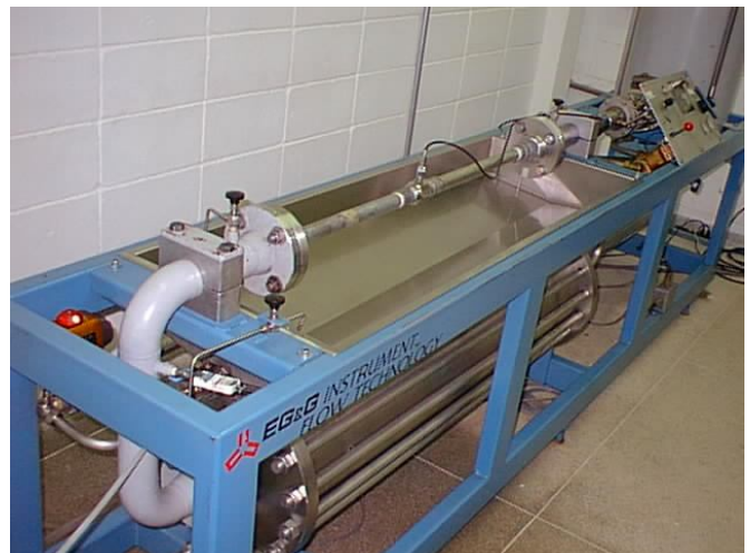
Calibrador de tipo Piston - Prover usado para la determinación del factor K de los medidores.
