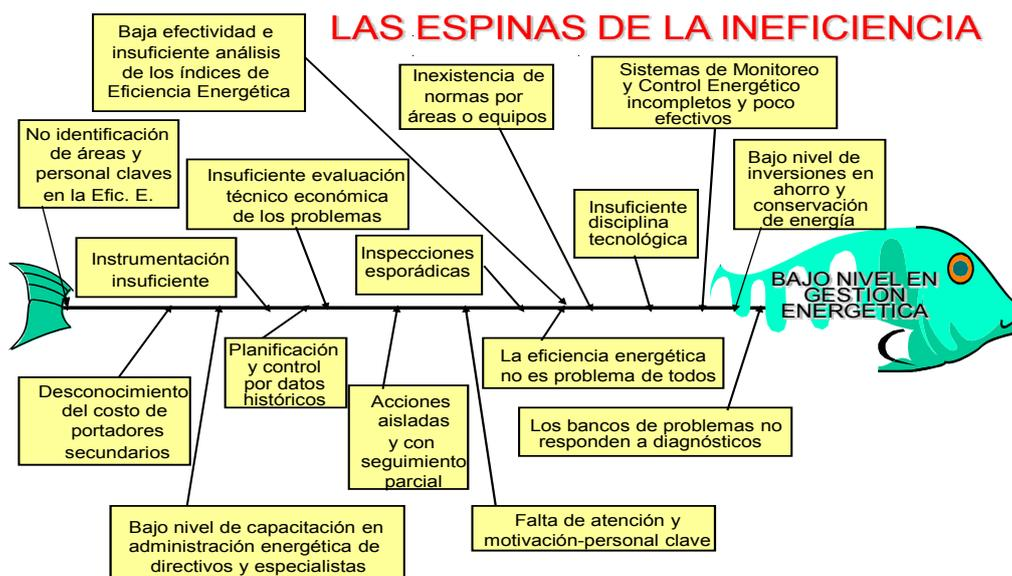
Fig. 8. Diagrama causa- efecto de la ineficiencia energética
