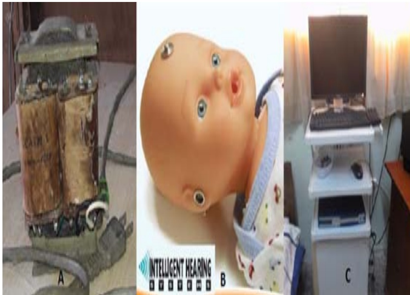
Fig.1. A: Generador de campo magnético construido a partir del transformador de televisor de tubo de rayos catódicos. B: Simulador de señales auditivas. C: Electroaudiómetro Audix V.
