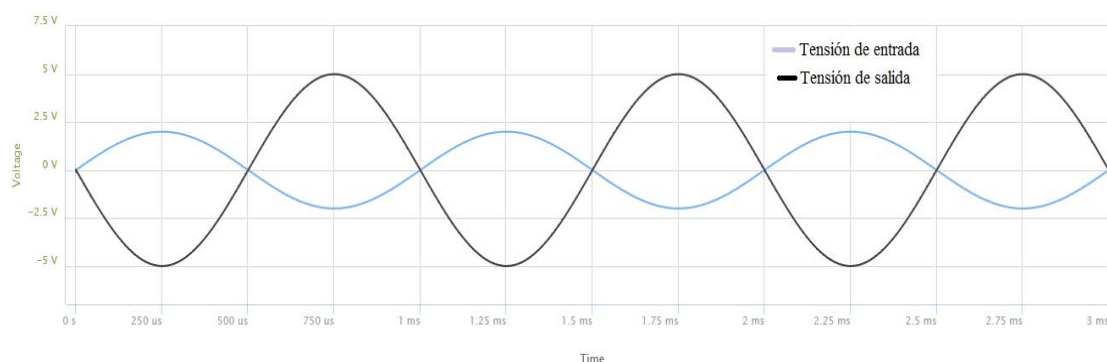
Fig. 12. Formas de ondas de las tensiones de entrada y salida del amplificador inversor implementado en PartSim
