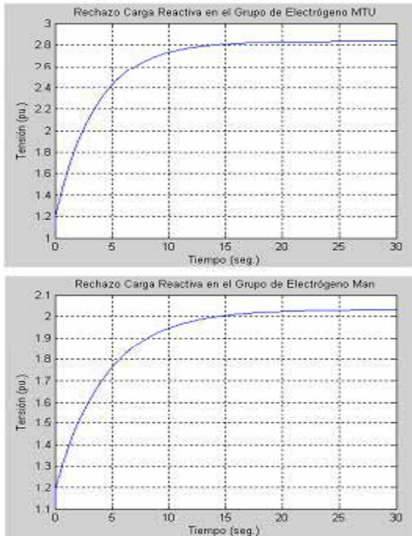
Variación de la tensión en los terminales de los GE al ocurrir una desconexión súbita de la carga.
