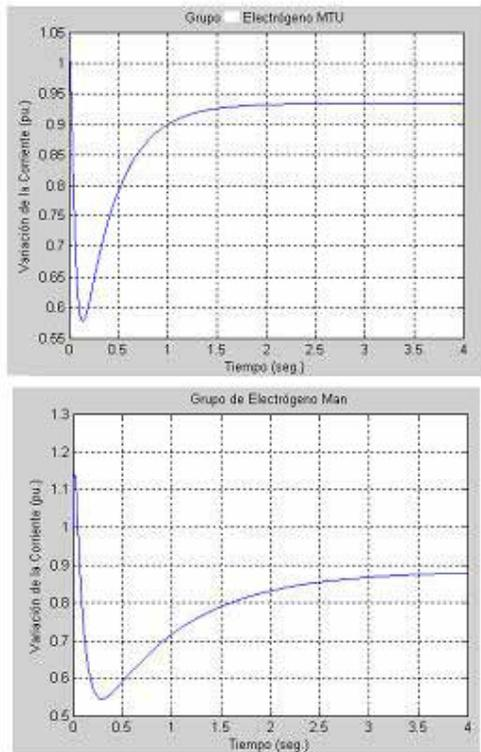
Variación de corriente del estator ante una U en el estator.
