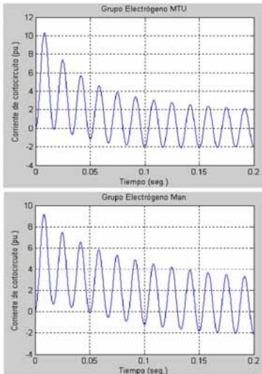
**Respuesta de los GE a un cc súbito, trifásico en los terminales del generador.**
