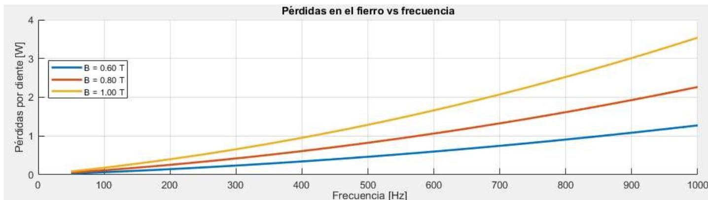
Fig. 5. Pérdidas en el hierro versus frecuencia para distintos valores de B
