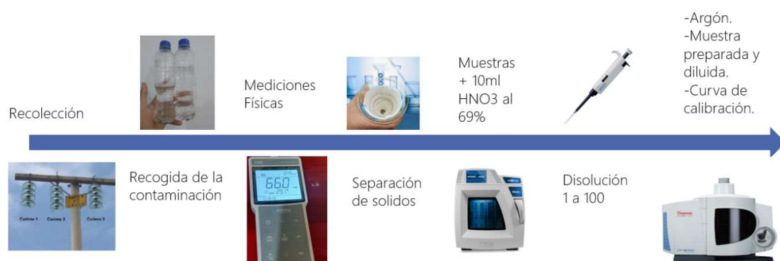
Fig. 2. Diagrama de flujo del análisis de las muestras. Fuente: (Autor)
